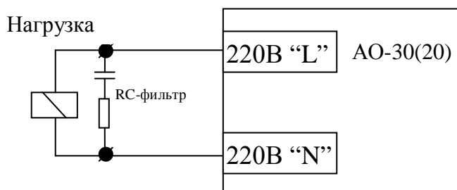
Рисунок 2 – Подключение RC-фильтра к индуктивной нагрузке
