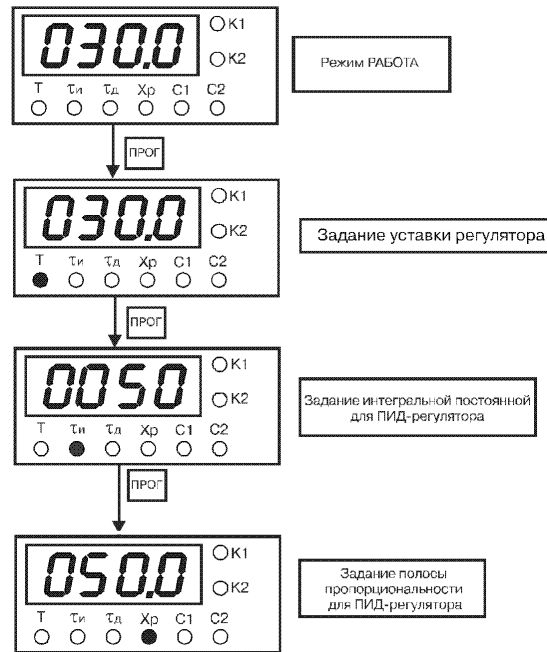
Рисунок 1 – Последовательность программирования регулятора (AK-05.XX PM)
